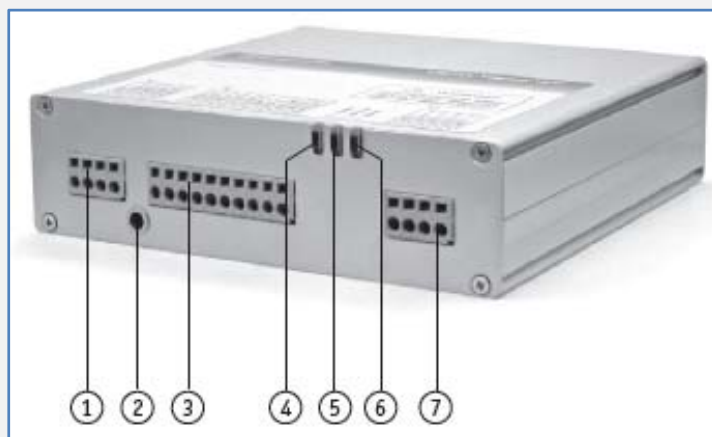
Figuur 3 Control Module CM15 met LED indicatoren
